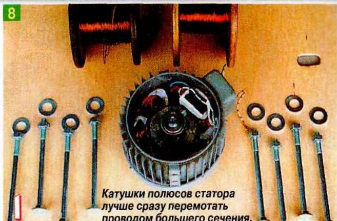
Катушки полюсов статора лучше сразу перемотать проводом большего сечения.
