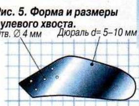
*Рис. 5. Форма и размеры рулевого хвоста.*
