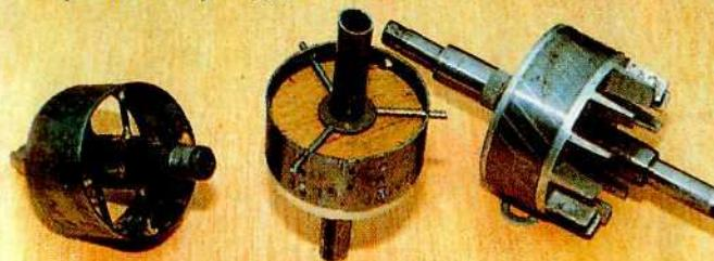
И второй способ — из стальной ленты по деревянной оправке сделать новый ротор, на который так же наклеить магниты.
