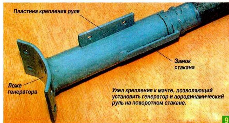
Узел крепления к мачте, позволяющий установить генератор и аэродинамический руль на поворотном стакане.
