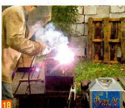
Духовку вырезал и сварил из 3-мм стали (фото 18) по размерам, определённым при макетировании (фото 19). Духовку перед установкой в кладку тоже
